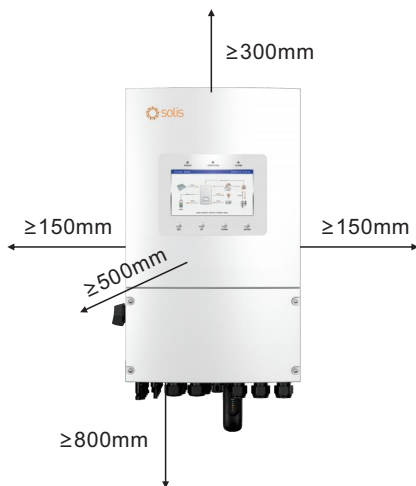
Figura 3.5 Distancias de montaje del inversor
