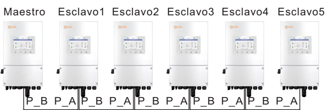
Figura 3.24 Conexión de terminales en paralelo
